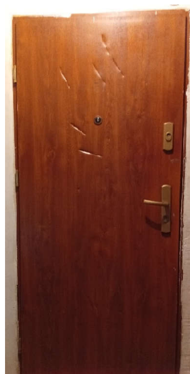
drzwi wzmocnione klasy RC3/RC4 po próbie sforsowania maczetą
